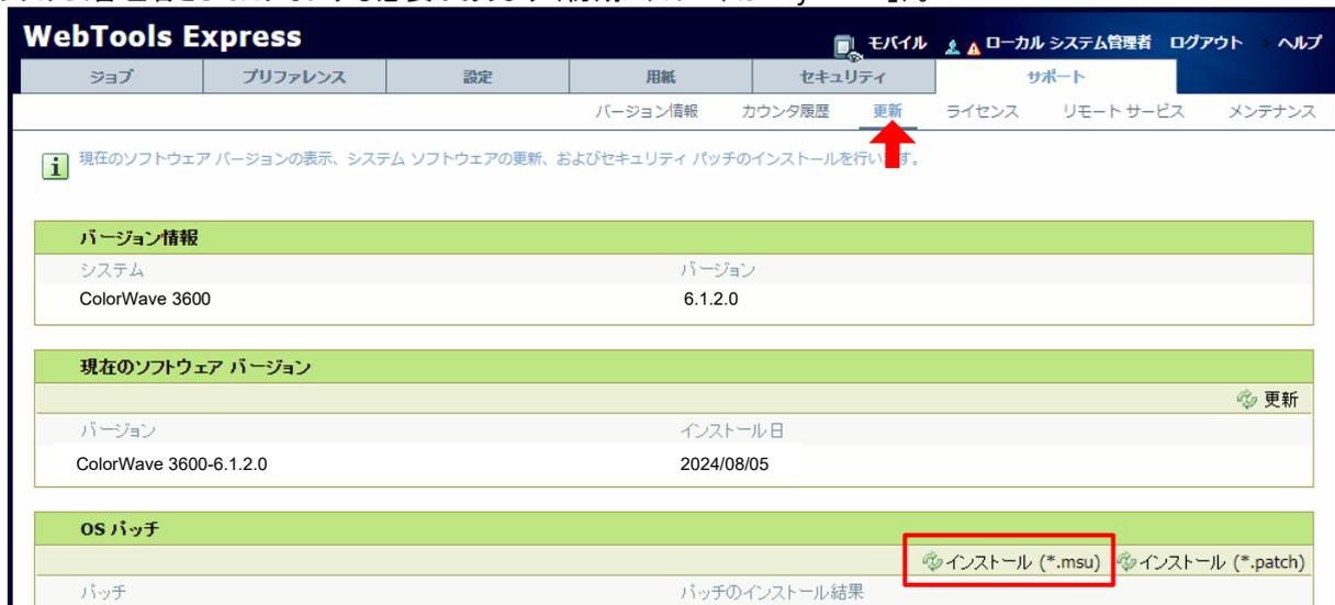
6. 「OSパッチ」項目右側の「インストール (\*.msu)」(手順5スクリーンショットの赤い四角部)をクリックすると、確認画面が現れます。「OK」をクリックします。
