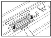
**11.** パネルユニットをゆっくり閉じます。そして、ユニットの両側を押し、カチッと音がしてロックされたことを確認します。
