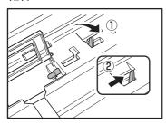
**7.** ローラーの軸の切り欠き部を本体の軸に合わせて、フィードローラーをセットします。
