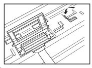
**10.** ローラーカバーを閉めます。カチッと音がしてカバーが元の位置に戻ったことを確認します。
