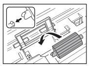
**8.** 固定レバーを矢印方向に動かし、フィードローラーの軸の穴に、はめ込みます。
