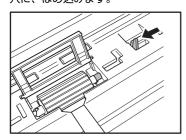
**9.** 固定レバーを倒してフィードローラーを固定します。
