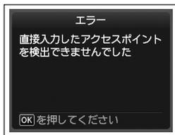
OK ボタンを押して入力したアクセスポイント名/ネットワーク名 (SSID) が正しいことを確認し、もう一度 OK ボタンを押してください。
