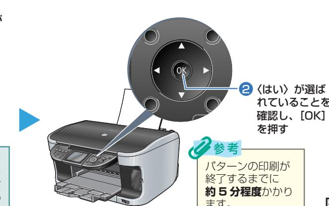
図のようなパターンが印刷されたら、プリントヘッド位置の調整は完了です。
