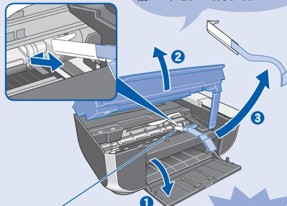
保護材を取り外す(保護材を取り外したら、スキャナユニット(プリンタカバー)を閉じてください)
