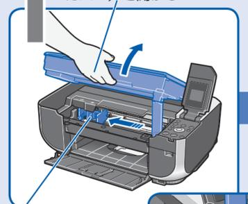
FINE カートリッジホルダが左側に移動する(液晶モニターには取り付け手順が表示されます)
