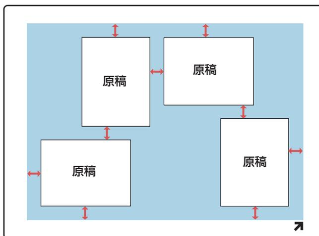
原稿と原稿の間、原稿台ガラスの端と原稿の間は、1cm 以上空けてください。原稿は、多少斜めになっていても、10 度以内の傾きであれば、自動的にまっすぐに修正されます。
