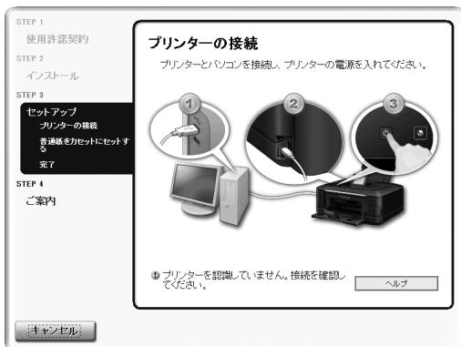
[プリンターの接続] 画面から先に進めなくなった場合は、本製品のUSBケーブル接続部とパソコンがUSBケーブルでしっかりと接続されていることを確認し、次の手順にしたがってインストールをやり直してください。
