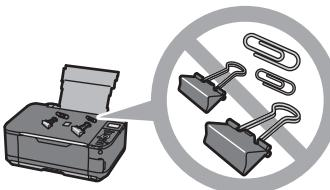
原稿台カバー上には物を置かないでください。原稿台カバーを開けたときに後トレイに物が落ち、故障の原因になります。また、上から物が落ちる場所などには、本製品を置かないでください。
