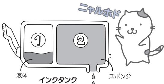
まず①がなくなると、インクランプがゆっくり点滅し、インクが少なくなったことをお知らせします。次に②がなくなると、インクランプの点滅がはやくなり、新しいインクタンクへの交換をお知らせします。
