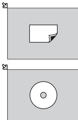
原稿台ガラスの端から10mm以上離し、読み取る面を下にして原稿を置いてください。
