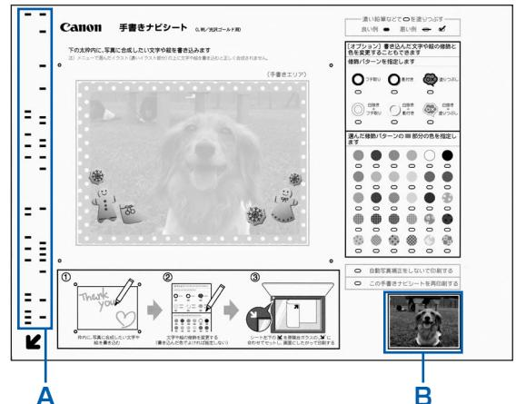
(A) 印刷設定情報がバーコードで表示されます。
