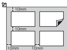
原稿台ガラスの端から10mm以上離し、読み取る面を下にして置いてください。原稿と原稿の間も10mm以上離してください。
