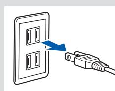
電源ボタンを押して電源を切ると、本製品は自動的にプリントヘッド（インクのふき出し口）にキャップをして乾燥を防ぐようになっています。ところが、電源ランプが消える前にコンセントから電源プラグを抜いてしまうと、プリントヘッドが正しくキャップされずに乾燥や目づまりの原因となります。
