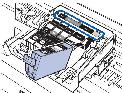
**1** 新しいインクタンクをプリントヘッドに向かって斜めに差し込む
