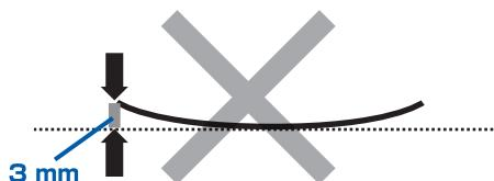
1 下の図のように、対角線上の端を、反りと逆方向に丸める
