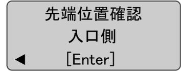
**5** セットされているチューブの先端位置を確認して[◀]または[▶]を押して先端位置を設定し、[Enter]を押す。
