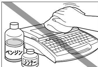
本体を拭くときは、水にしめらせて固くしぼったガーゼを使用し、アルコール、ベンジン、シンナーなどの引火性溶剤は使用しないでください。溶剤が内部の電気部品に触れて火災や感電の原因になります。
