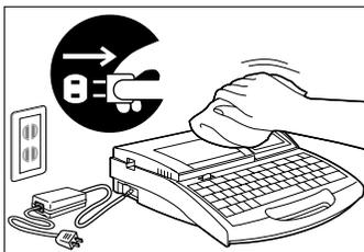
清掃するときは電源スイッチをOFFにし、ACアダプタのプラグを電源コンセントから抜いてください。万一電源スイッチが入って本体が動作するとケガの原因になります。
