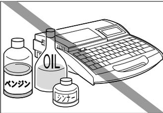
アルコールやシンナーなど引火性溶剤の近くに置かないでください。溶剤が内部の電気部品に触れると火災の原因になります。
