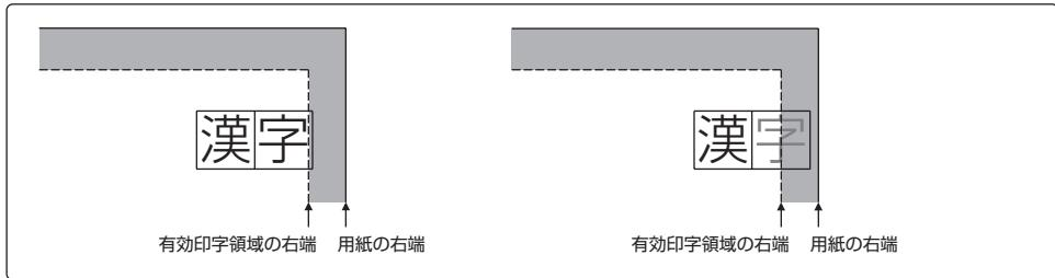
文字にアンダーラインを引いている場合、同様に文字幅が有効印字領域を越えなければ、文字およびアンダーラインを印字しますが、文字幅が有効印字領域を越える場合は、文字を印字せずに有効印字領域内のアンダーラインだけを印字します。
