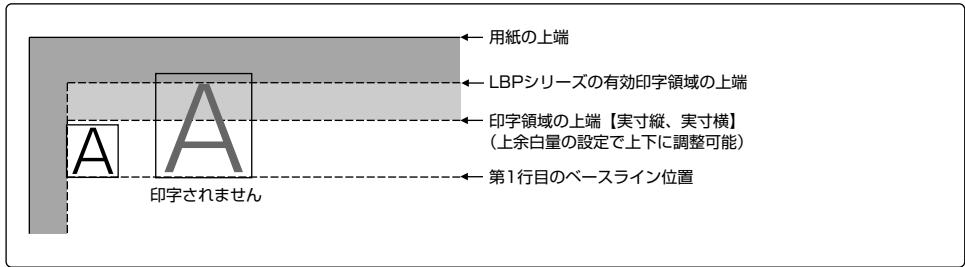
ページフォーマットFmode 3, 4, 6, 7, 8では、初期状態のときの先頭行（TOF行）の印字位置は、ページフォーマットおよび用紙サイズによって異なります。それぞれのページフォーマットでの印字領域の上端は、LBPシリーズの有効印字領域の上端から次の量だけオフセットした位置になります。
