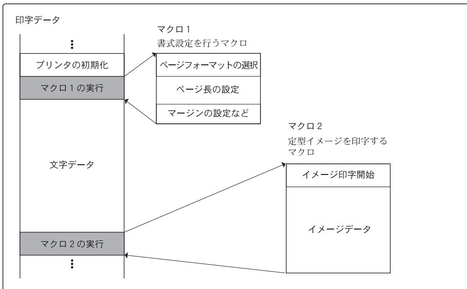
このように、マクロを使用すると、データ量を削減することができるので、印字処理を効率よく行うことができます。
