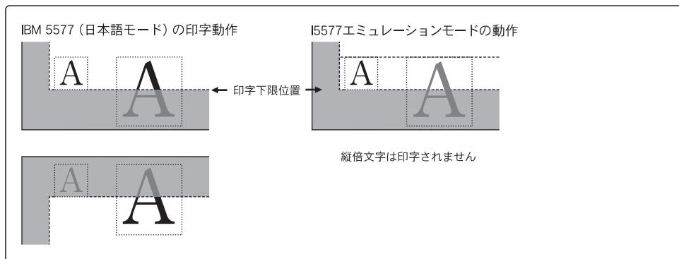
なお、IBM5577の英語モードでは、ブロックグラフィックキャラクタ編集文字およびブロックグラフィックキャラクタ編集を指定した登録文字（ダウンロード文字）は、通常の文字より6ドット（180dpi）下方向に大きいため、下端付近でこの文字を印字した場合に文字の上部24ドット（180dpi）分を印字して改ページし、下部6ドット（180dpi）分を印字します（トラクタフィーダ使用時は、ミシン目にまたがって印字されます）。同様に、ダウンロード文字のアンダーライン編集は2ドット（180dpi）下方向に大きいため、2ドット分が次ページに印字されます。
