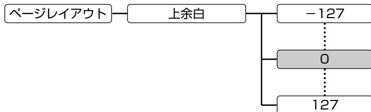
それぞれのページフォーマットで設定されているTOF行の上端を基準として、印字開始位置を上下方向にずらす量を255段階で指定します。
