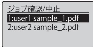
[ジョブ確認 / 中止]を押して、次の画面が表示された場合は、OKを押してジョブをキャンセルします。
