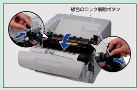
図のように定着器の左右にある緑色のロック解除ボタンを 押しながら取っ手を持って定着器を前に倒します。
