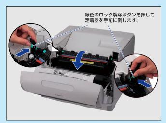
図のように定着器の左右にある緑色のロック解除ボタンを押しながら 取っ手を持って定着器を前に倒します。
