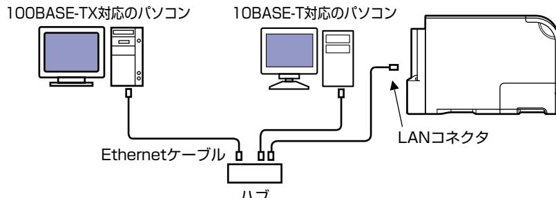
**△注意** プリンタにネットワークケーブルを接続するときは、必ずプリンタの電源をオフにし、電源コンセントから電源プラグを抜いてから行ってください。感電の原因となることがあります。
