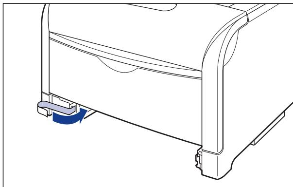
**10** 紙力セット内部の梱包材を取り外します。
