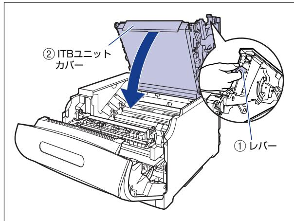
図のように上カバーの「PUSH」と記載されている部分を押して、上カバーを突き当たるまで確実に閉めます。
