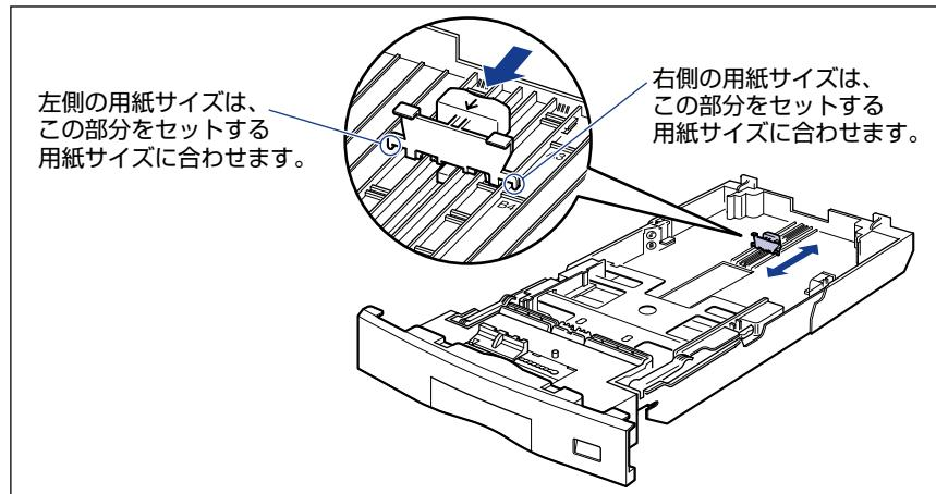
**4** 側面の用紙ガイドのロック解除レバーをつまみながら、セットする用紙サイズに合わせます。
