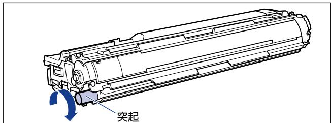
**20** 取り付けた色のドラムカートリッジの水色のつまみを「固定」の位置までスライドさせて、ドラムカートリッジを固定します。
