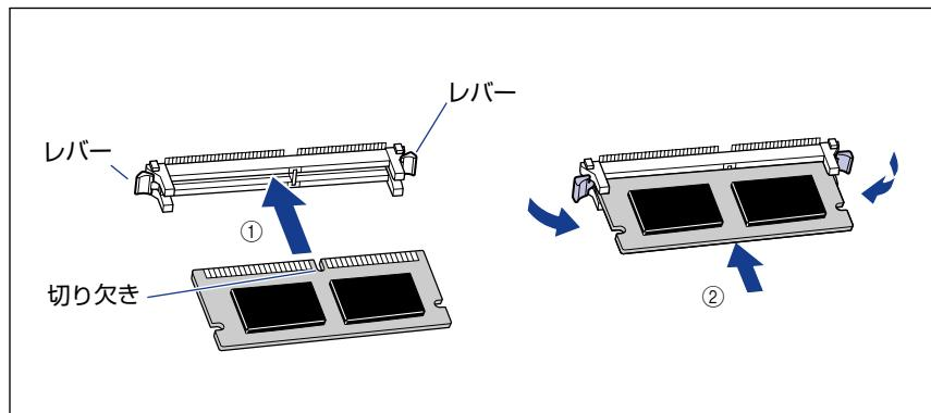
RAMが正しく取り付けられると、RAMスロット両端のレバーでロックされます。
