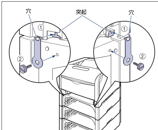
プリンタ本体のカセット保護カバーを上げながら ③、部材の突起をプリンタの穴に取り付け④、ネジで固定します ⑤。
