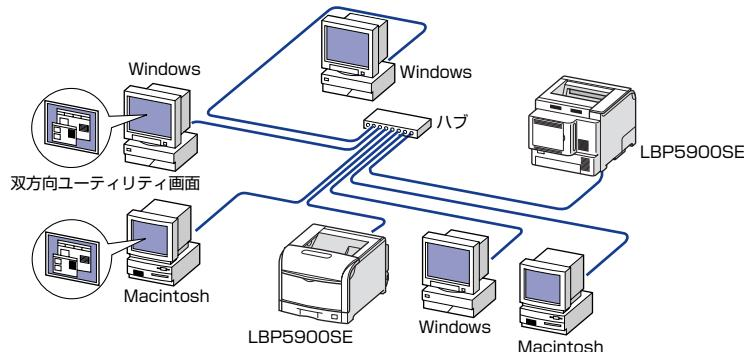
本プリンタは、10BASE-T/100BASE-TX 対応のプリントサーバを標準装備しており、ネットワークへ直接接続して Windows、Macintosh、UNIX などのパソコンからプリンタを共有することができます。本プリンタのプリントサーバは TCP/IP、AppleTalk (EtherTalk)、SMB のプロトコルに対応しています。
