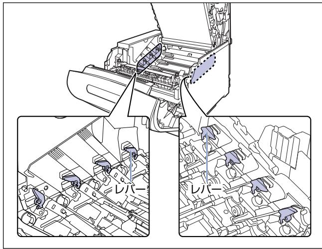
正しい位置にレバーがないとドラムカートリッジを取り付けることはできません。図のようにレバーを正しい位置まで押し上げます。
