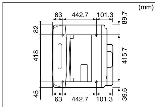
**メモ** ゴム足の高さは 6mm、先端は前側 15mm × 23mm、後側 24mm × 10mm の長方形です。
