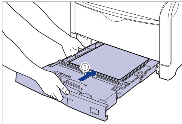
給紙力セットの手前を少し持ち上げてから ②、給紙力セットの前面が、プリンタの前面と揃うまで、しっかりと奥まで押し込みます ③。
