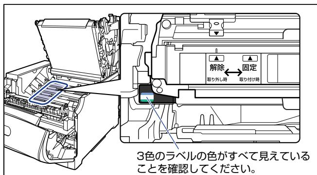
3色のラベルの色すべてが手前に見えない場合は、一度取り出して、突起を矢印の方向にカチッと止まるまで回してから、取り付け直してください。
