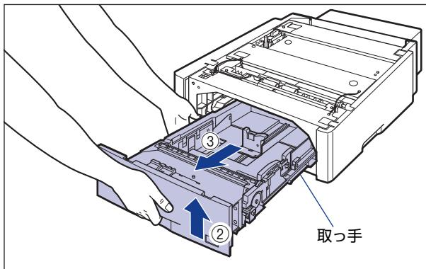
図のように給紙カセットを両手で持って、完全に引き出します④。
