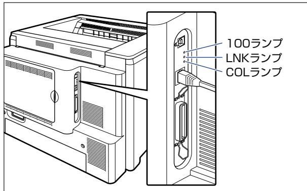
正常に動作していない場合は、LAN ケーブルの接続やハブの動作状態を確認してください。他の機器がすべて正常に動作している場合は、プリンタの電源をオフにし、プリントサーバの通信設定 (Ethernet ドライバの設定) を接続したネットワークに合わせて変更してください。(→ネットワークガイド／本編「第2章 ネットワーク共通設定」)
