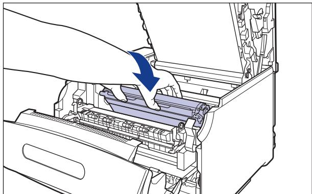
図のようにドラムカートリッジの左右の突起をドラムカートリッジガイドに挿入します。
