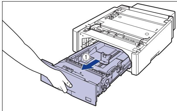
給紙力セットの手前を少し持ち上げてから②、左手をそえて給紙力セット右側にある取っ手が完全に見えるまで、引き出します③。
