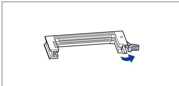
7 ROM の切り欠きをレバーの反対側にしてスロットガイドに合わせて差し込み、奥までしっかりと押し込みます。
