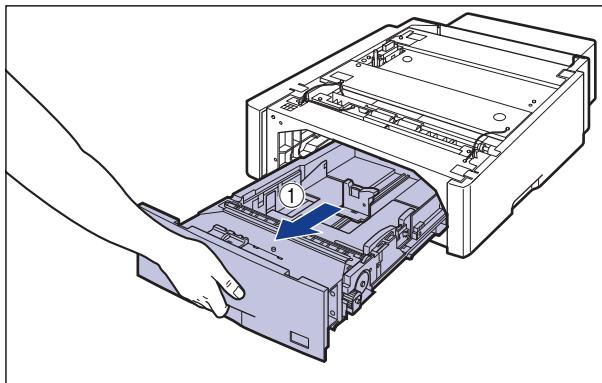
紙力カセットの手前を少し持ち上げてから②、左手をそえて紙力カセット右側にある取っ手が完全に見えるまで、引き出します③。
