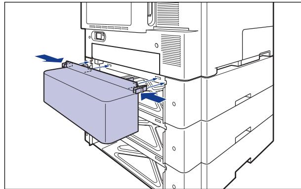
**重要** カセット保護カバーに手をかけたり、強く押したり、物を置いたりしないでください。カセット保護カバーが破損する恐れがあります。
