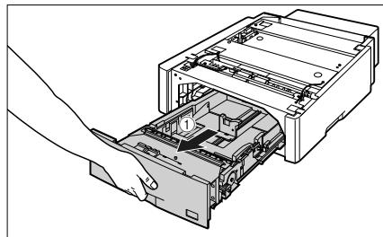
給紙力セットの手前を少し持ち上げてから②、左手をそえて給紙力セット右側にある取っ手が完全に見えるまで、引き出します③。
