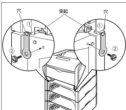
プリンタ本体のカセット保護カバーを上げながら③、部材の突起をプリンタの穴に取り付け④、ネジで固定します⑤。
