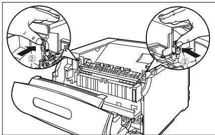
**6** 図のように両手で前カバーに手をそえて①、両手で前カバーを押して、しっかりと閉めます②。
