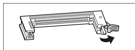
**7** ROM の切り欠きをレバーの反対側にしてスロットガイドに合わせて差し込み、奥までしっかりと押し込みます。
