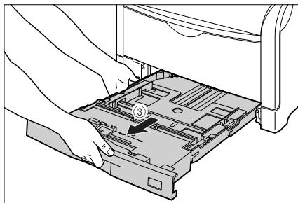
給紙カセットの長さを調整するには、ロック解除レバーをゆっくりと持ち上げロックを解除し、給紙カセットの後部を持ってスライドさせ、ロック解除レバーを押し下げてロックします。
