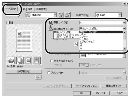
**3** [給紙] ページをクリックして、[給紙部]で[手差し(トレイ)]、[用紙タイプ]でセットした用紙のタイプを選択します。
