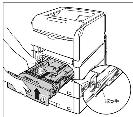
図のように給紙力セットを両手で持って、完全に引き出します④。
