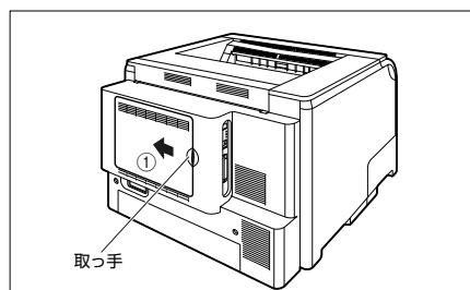
後カバーを少し開けて②、矢印の方向に後カバーを取り外します③。
