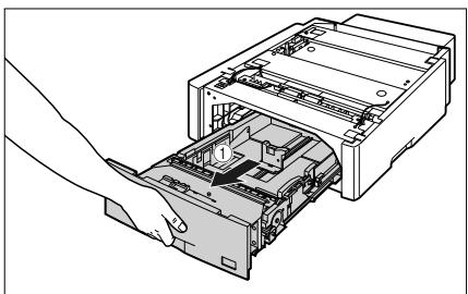
紙力セットの手前を少し持ち上げてから②、左手をそえて紙力セット右側にある取っ手が完全に見えるまで、引き出します③。
