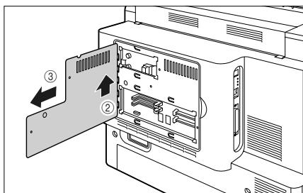
RAM の取り付ける位置は以下のとおりです。取り付け位置を確認してから RAM を取り付けてください。
