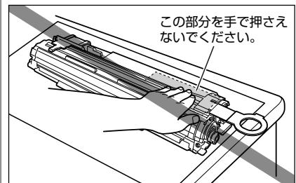
シーリングテープを引き抜くときは、ドラム保護シャッターを手で押さえつけないように気を付けて作業を行ってください。
