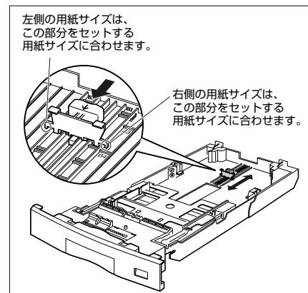
**c** 側面の用紙ガイドのロック解除レバーをつまみながら、セットする用紙サイズに合わせます。
