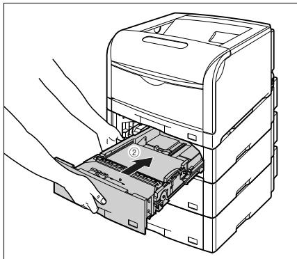
給紙力セットの手前を少し持ち上げて ③、給紙力セットの前面が、ペーパーフィーダの前面と揃うまで、しっかりと奥まで押し込みます ④。
