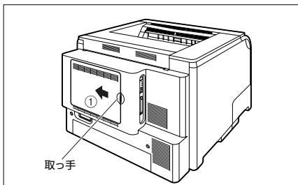
後カバーを少し開けて ②、矢印の方向に後カバーを取り外します ③。
