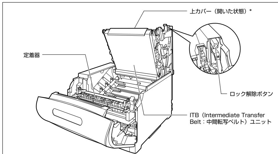
\* ドラムカートリッジを交換するときやプリンタ内部を清掃するときに、ここを開けて作業します（紙づまりを除去するときは、開ける必要があります）。上カバーは、前カバーを開けて定着器を手前に倒してから、ロック解除ボタンを押して開けます。
