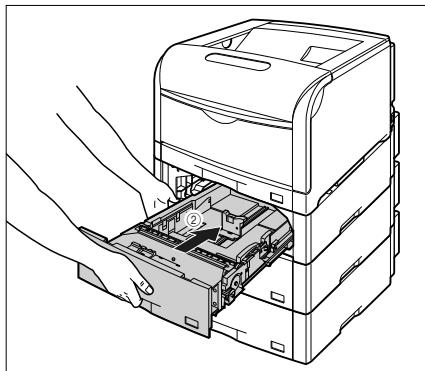
給紙カセットの手前を少し持ち上げて ③、給紙カセットの前面が、ペーパーフィーダの前面と揃うまで、しっかりと奥まで押し込みます ④。
