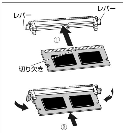
RAM が正しく取り付けられると、RAM スロット両端のレバーでロックされます。
