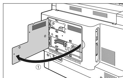
スロットカバーを少し持ち上げて②、矢印の方向にスロットカバーを取り外します③。
