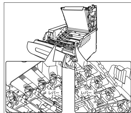
正しい位置にレバーがないとドラムカートリッジを取り付けることはできません。図のようにレバーを正しい位置まで押し上げます。
