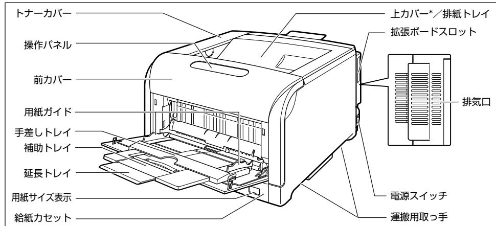
\* ドラムカートリッジを交換するときやプリンタ内部を清掃するときに、ここを開けて作業します（紙づまりを除去するときは、開ける必要はありません）。上カバーは、前カバーを開けて定着器を手前に倒してから、ロック解除ボタンを押して開けます。ロック解除ボタンの位置については、「プリンタ内部」(→ P.1-3) を参照してください。
