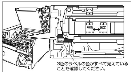
3色のラベルの色すべてが手前に見えない場合は、一度取り出して、突起を矢印の方向に力ちっくと止まるまで回してから、取り付け直してください。
