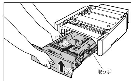
図のように給紙カセットを両手で持って、完全に引き出します④。
