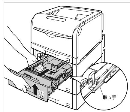
図のように給紙カセットを両手で持って、完全に引き出します④。
