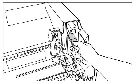
**5** 取っ手を持って定着器を元の位置に戻し ①、左右の取っ手を図のように押します ②。
