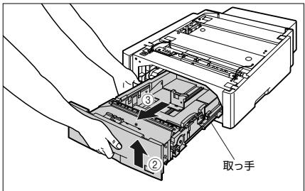
図のように紙力セットを両手で持って、完全に引き出します④。
