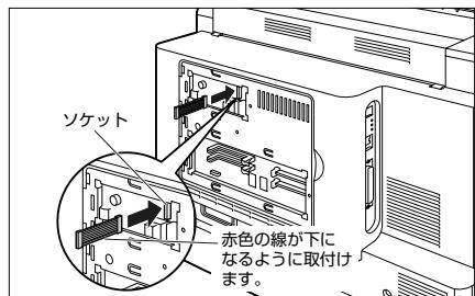
**10** ハードディスクを拡張ボードスロットに差し込み ①、コネクタが合うようにしっかりと差し込みます ②。
