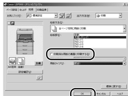
**5** [OK]をクリックして、印刷を実行します。
