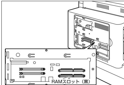
**6** 黒色の RAM スロットへ図のように切り欠きに合わせて差し込み ①、奥までしっかりと押し込みます ②。
