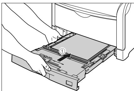
給紙カセットの手前を少し持ち上げてから ②、給紙カセットの前面が、プリンタの前面と揃うまで、しっかりと奥まで押し込みます ③。
