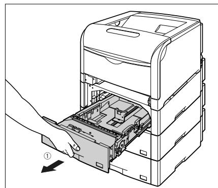
給紙力セットの手前を少し持ち上げてから②、左手をそえて給紙力セット右側にある取っ手が完全に見えるまで、引き出します③。
