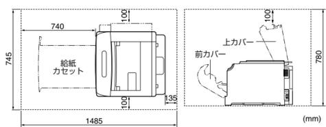
必ず、図に示すスペースを確保してください。プリンタ本体は約50kgあり、トナーカートリッジとドラムカートリッジを取り付けると約58.9kgになります。オプションのペーパーフィーダを3台取り付けると約91.9kgになります。必ず、本プリンタやオプション品の質量に耐えられる十分な強度のある場所に設置してください。くらついた台の上や傾いた所などの不安定な場所、振動の多い場所、パソコンラックの上段などに設置しないでください。落ちたり倒れたりして、けがの原因になることがあります。本プリンタを設置する前に、詳しい設置環境について、本プリンタに付属の「設置時にお読みください」を必ずお読みください。
