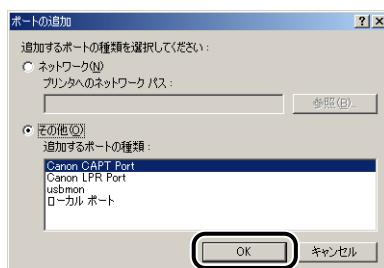
**22** [利用可能なネットワークプリンタ] から NetSpot Device Installer、ARP/PING コマンド、またはプリンタステータスウィンドウで設定した IP アドレスのポートを選択し、[OK] をクリックします。
