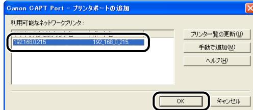
[利用可能なネットワークプリンタ] に目的のプリンタのポート名が表示されていない場合は、[プリンター覧の更新] をクリックします。それでも表示されない場合は、[手動で追加] をクリックして、[手動で追加] ダイアログボックスの [IP アドレスまたはプリンタ名] に IP アドレスまたはプリンタ名 (DNS サーバに登録する DNS 名 (最大で半角 78 文字)) を入力し、[OK] をクリックします。プリンタの IP アドレスを設定する方法によって、入力する値が異なります。詳しくは、「ポートを追加するときの設定について (Windowsのみ)」(→P.5-17) を参照するか、ネットワーク管理者へお問い合わせください。
