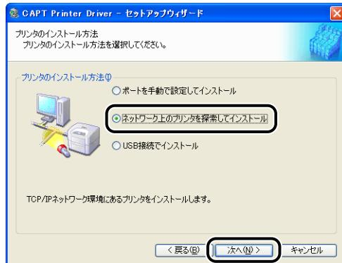
ネットワーク上の TCP/IP ポートを探して、プリンタを自動的に検出します。
