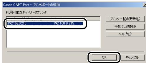
[利用可能なネットワークプリンタ] に目的のプリンタのポート名が表示されていない場合は、[プリンター一覧の更新] をクリックします。それでも表示されない場合は、[手動で追加] をクリックして、[手動で追加] ダイアログボックスの [IP アドレスまたはプリンタ名] に IP アドレスまたはプリンタ名 (DNS サーバに登録する DNS 名 (最大で半角 78 文字)) を入力し、[OK] をクリックします。プリンタの IP アドレスを設定する方法によって、入力する値が異なります。詳しくは、「ポートを追加するときの設定について (Windowsのみ)」(→P.5-17) を参照するか、ネットワーク管理者へお問い合わせください。
