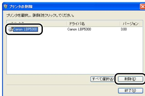
**メモ** [プリンタの削除] ダイアログボックス内のリストに本プリンタが表示されていない場合でも、[削除] をクリックすると本プリンタに関連するファイルおよび情報を削除することができます。
