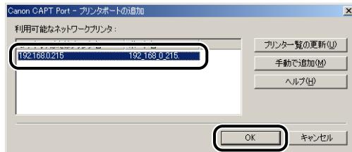
[利用可能なネットワークプリンタ] に目的のプリンタのポート名が表示されていない場合は、[プリンタ一覧の更新] をクリックします。それでも表示されない場合は、[手動で追加] をクリックして、[手動で追加] ダイアログボックスの [IP アドレスまたはプリンタ名] に IP アドレスまたはプリンタ名 (DNS サーバに登録する DNS 名 (最大で半角 78 文字)) を入力し、[OK] をクリックします。プリンタの IP アドレスを設定する方法によって、入力する値が異なります。詳しくは、「ポートを追加するときの設定について (Windows のみ)」(→P.5-17) を参照するか、ネットワーク管理者へお問い合わせください。
