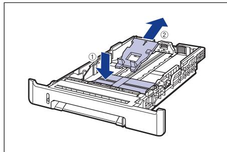
**重要** 給紙カセットには、梱包材が取り付けられています。必ず給紙カセットを取り出し、梱包材を取り外してください。
