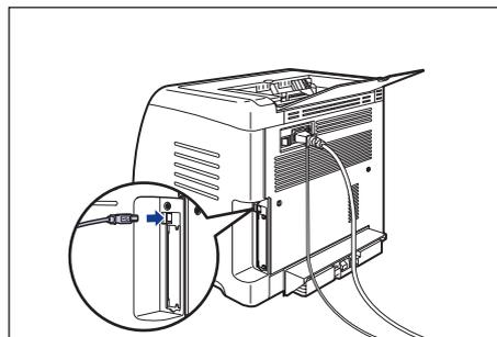
**3** USBケーブルの A タイプ(平たい側)をコンピュータの USB ポートへ接続します。
