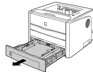
7 給紙カセット内部の梱包材を止めているテープ (2箇所) を取り外します。
