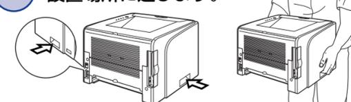
本プリンタは、給紙カセット、トナーカートリッジを取り付けていない状態で約10kgあります。必ず運搬用取っ手 (矢印で示した部分) を持ち、プリンタ前面から手を掛け、両手でしっかり持ってください。
