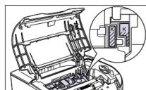
※交換位置まで来ていない場合は、上カバーを閉め、プリンタの動作音が止まってから上カバーを開けます。交換する色のトナーカートリッジが交換位置に来るまで、上カバーの開閉を繰り返してください。
