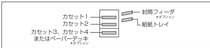
一番下の給紙元表示ランプは、2 × 500 枚ペーパーデッキが装着されている場合は、「カセット 3」、「カセット 4」共通の給紙元表示ランプとして点灯します。また、2000 枚ペーパーデッキを装着している場合は「ペーパーデッキ」の給紙元表示ランプとして点灯します。
