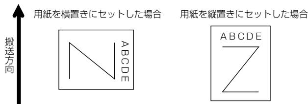
「ヨコ」に設定すると、用紙をセットした向き（置きかた）に関わらず、用紙を横に使用してプリントします。
