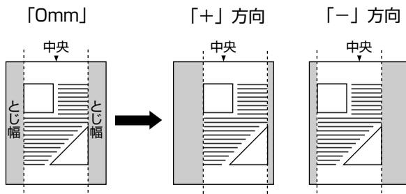
用紙の長短どちらの辺にとじ代をあげるのかは「とじ方向」(→前項目)で設定します。用紙の上下左右のどの辺にとじ代をあげるかは、「とじ方向」の設定と本項目の設定を「+」にするか「-」にするかの組み合わせにより決まります。
