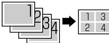
「4 ページ (タテミギ)」に設定すると、4 ページ分のデータを、右上から縦方向に並べてプリントします。
