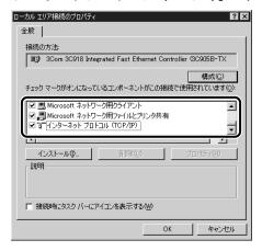
**2** [インターネットプロトコル (TCP/IP)] をダブルクリックして、[インターネットプロトコル (TCP/IP) のプロパティ] ダイアログボックスを表示します。
