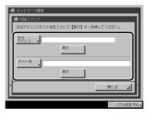
[IPv6 アドレス] にネットワーク上に存在する任意の IPv6 アドレスを入力したあと [実行] を押すと、タッチパネルディスプレイに PING コマンドの実行結果が表示されます。
