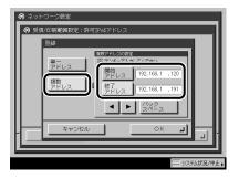
□ <受信/印刷範囲設定>の [拒否IPv4アドレス] の<設定を有効にする>: [ON]
