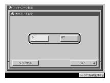
[ON]:キヤノン製のドライバやユーティリティソフトウェア(LIPS プリンタドライバ、 NetSpot Device Installer など)から、本製品の詳細情報の設定や参照が可能です。
