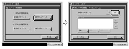
□ <受信/印刷範囲設定>の「拒否IPv6アドレス」の<設定を有効にする>: [OFF]
