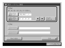
DNS の動的更新機能を使用する場合は、「プライマリ DNS サーバ」に DNS サーバの IP ア ドレスを入力します。
