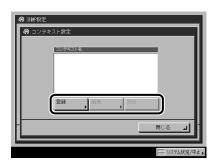
コンテキストを追加する場合は、[登録]を押して、新しいコンテキストを追加してください。コンテキストを変更する場合は、変更するコンテキストを選択したあと[編集]を押してコンテキスト名を変更してください。コンテキストを削除する場合は、削除するコンテキストを選択したあと[消去]を押してください。
