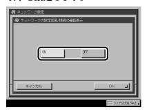
[ON]:ネットワーク接続に関係するエラーなどが発生した場合、各種メッセージがタッチパネルディスプレイ上に表示されます。本製品をネットワーク環境で使用する場合は[ON]を選択してください。
