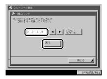
ネットワーク上に存在する任意の IP アドレスを入力したあと「実行」を押すと、タッチパ ネルディスプレイに PING コマンドの実行結果が表示されます。
