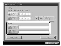
DNS の動的更新機能を使用する場合は、[プライマリ DNS サーバ] に DNS サーバの IPv6 アドレスを入力します。
