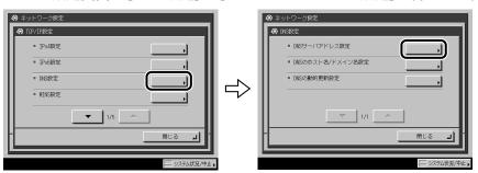
5 「DNS サーバアドレス設定」のくIPv4 >で、以下を設定します。
