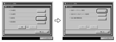
8 「DNS サーバアドレス設定」の<IPv6 >で、以下を設定します。
