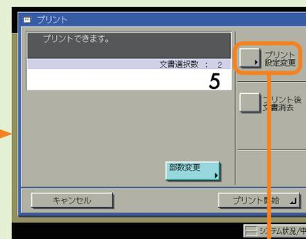
プリント画面では、部数、プリント後文書消去、試しプリントの設定ができます。[プリント設定変更]を押すとプリント設定変更画面が表示されます。レイアウトを変更したいときはプリント設定変更画面の機能を使用してください。
