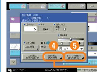
次の束を読み込むときは [次の束の読込設定] を押して3へ。すべての読み込み終了後 [すべての束の確認/結合] を押します。
