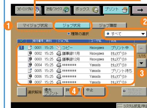
タッチパネルディスプレイ上部の[プリント]を押すことでも、プリント待ち／プリント中のジョブを中止することができます。[ジョブ状況]を押したあと、ドロップダウンリストから、中止するジョブの種類を選択してください。
