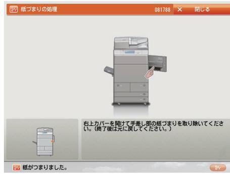
**警告** 製品内部には、高圧になる部分があります。紙づまりの処理など内部を点検するときは、ネックレス、プレスレットなどの金属物が製品内部に触れないように点検してください。やけどや感電の原因になることがあります。
