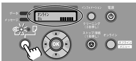
ロール紙やカット紙が残っている場合は、[OK] キーを押すと用紙が排紙されます。自動カットできない用紙種類の印刷物が残っている場合は、印刷物をカッターもしくはハサミで切り取ります。印刷物を取り除いたら、リリースレバーを上げてからロールホルダーを回してロール紙を巻き取り、リリースレバーを下げてください。
