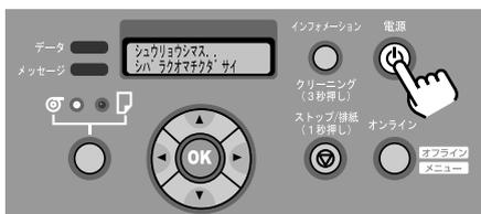
ディスプレイに「シバラク オマチクダサイ」が表示された後、プリンタの電源がオフになります。
