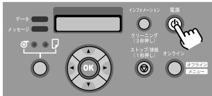
プリンタが起動した後ロール紙の給紙準備が始まり、完了すると印刷できる状態になります。
