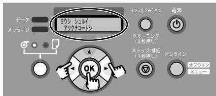
設定値の左に「=」が表示され、用紙種類が設定されます。用紙種類の設定値については、下表をご覧ください。ディスプレイには、プリンタにセットされているブラックインクの種類により、使用可能な用紙種類のみが表示されます。
