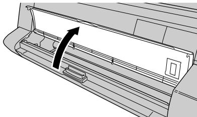
ディスプレイに「ロールシトレイ アケテクダサイ」が表示されます。すでにロール紙がトレイにセットされている場合は、「トレイシメテクダサイ」が表示されます。
