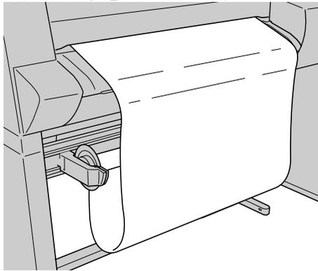
**12** 巻き取り装置の巻き取りスイッチを下に押して、たるみがなくなるまで用紙を巻き取ります。
