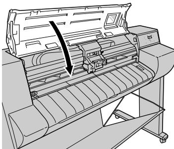
上カバーを閉じると、ディスプレイに「シバラクオマチクダサイ」が表示され、処理が始まります。処理には、染料機の場合は約3分半、顔料機の場合は約17分かかります。処理が終わると、自動的に「パターン インサツ A」が印刷されます。引き続き、プリントヘッドの調整を行ってください。(→第7章「プリントヘッドを調整する」P.7-34)
