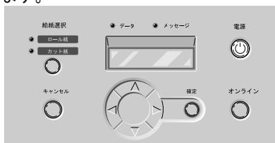
オンラインランプやメッセージランプが点滅したあと、準備処理が始まります。準備が終わり、用紙がセットされているとオンラインランプが点灯してディスプレイに「オンライン」が表示され、印刷できる状態になります。
