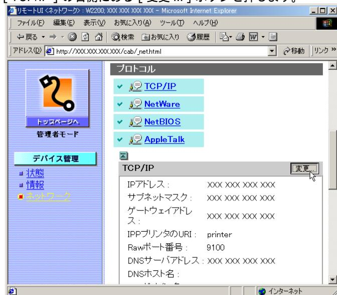
[ TCP/IP プロトコル設定の変更 ] ページが表示されます。
