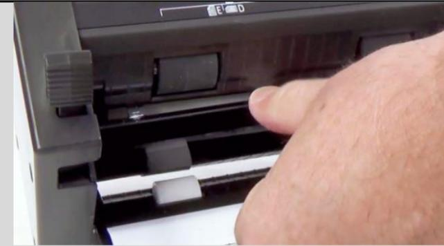
4. ガラスをスキャナーに取り付ける前に糸くずのでないきれいな布でガラスの裏側を清掃します。再度スキャナーに取り付けるとき、清掃した部分に触らないように気を付けてください。
