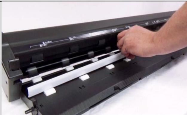
10. 新しいホールドアッププレートの裏側の接着テープの接着保護テープを剥がします。
