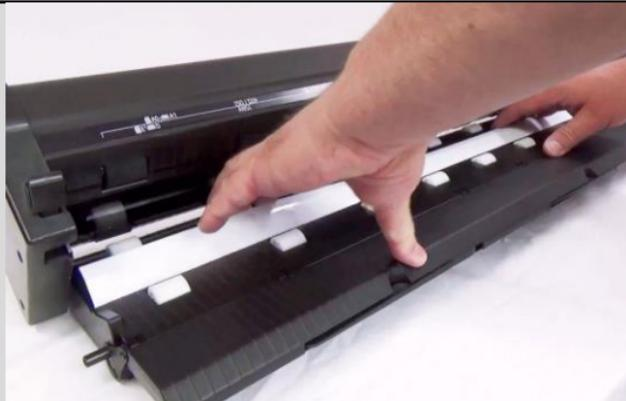
8. 指先でスキャナー全幅のホールドアッププレートを慎重にスプリングブラケットから外します。
