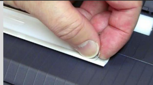
12. ホールドアッププレートをスプリングブラケットにしっかりと全幅を押して接着します。
