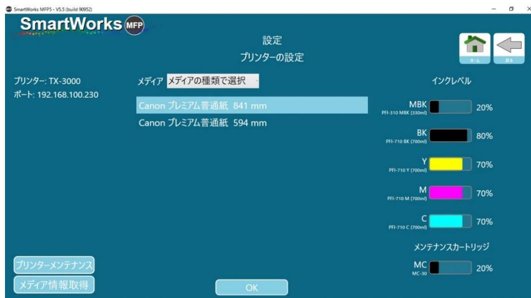
ロールユニットを搭載し、2段ロール給紙に対応したプリンターの場合、「メディア」で用紙の選択方法を決め、セットされている用紙情報の選択と組み合わせ、コピーやプリントに使用する用紙を指定します。デフォルトでは上段ロール紙が選択されます。
