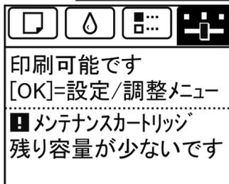
メンテナンスカートリッジ交換のメッセージが表示されている場合は、[メンテナンスカートリッジ交換のメニューを選択する]の操作は不要です。[メンテナンスカートリッジを交換する]に進んでください。
