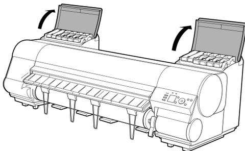
**2** インクタンク固定レバーのストッパー(a)を持ち上げて、インクタンク固定レバーを止まるところまで引き上げてから、手前に倒します。
