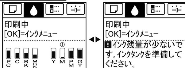
インクタンクの交換を指示するメッセージが表示されている場合は、[OK]キーを押します。この場合は、[インクタンク交換のメニューを選択する]の操作は不要です。[インクタンクを取り外す]に進んでください。
