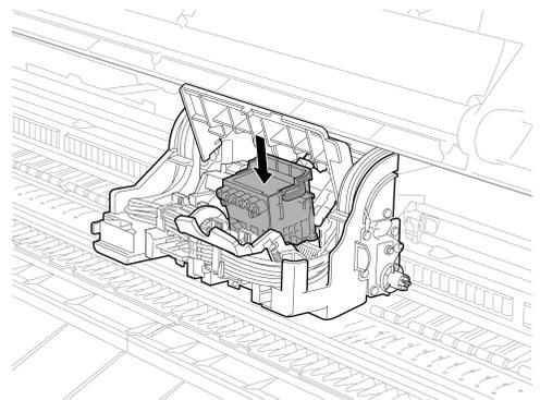
**11** プリントヘッド固定カバーを前側に倒して、プリントヘッドをロックします。
