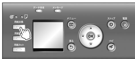
2. [▲]キー、[▼]キーを押して[カット紙をセットする]を選択し、[OK]キーを押します。
