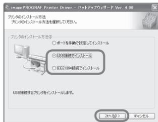
3. 以下のダイアログボックスが表示されたら、USB/IEEE1394 (FireWire) ケーブルでプリンタとコンピュータを接続します。
