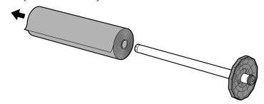
• [フチなし印刷用スペーサー]を取り付けている場合 図のように[フチなし印刷用スペーサー]を[ロールホルダー]から取り外します。
