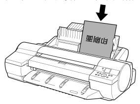
**7** [幅ガイド] (a) の位置をセットした用紙のサイズに合わせて調整します。 セットした用紙が傾いたりしわにならないように、[幅ガイド]を用紙にぴった り合わせてください。
