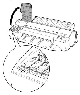
**6** 交換する色の[インクタンク固定レバー]の先端ストッパーを押して、[インクタンク固定レバー]を上に開きます。
