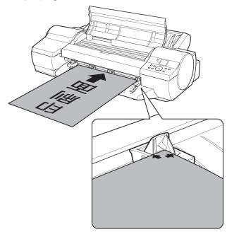
**7** [上カバー]内部を見ながら、用紙の先端を[用紙押さえ](a)に対して平行にして[プラテン]と[用紙押さえ](a)の間に差し込み、[前面給紙ガイド]の[紙合わせライン](b)に合わせます。
