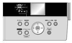
[データランプ]が点滅している場合は、印刷ジョブを受信中です。印刷が終了してから電源をオフにしてください。
