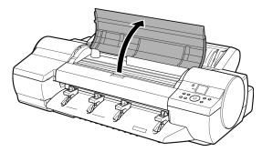
**6** [プラテン]上の[吸引口](a)や[フチなし印刷インク受け溝](b)に紙粉がたまっている場合は、プリンタに同梱されている[クリーナブラシ]で掃き取ります。
