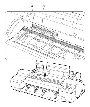
**8** [上カバーを閉じてください。]と表示されたら、[上カバー]を閉じ、[OK]キーを押します。
