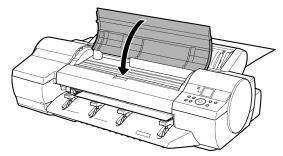
[プラテン]と[背面カバー]の間に固定され、給紙されます。 給紙が完了すると、オンラインモードになり、自動的に印刷を開始します。 事前にコンピュータから印刷ジョブを受信していない場合は、印刷待機の状態 になります。
