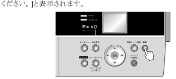
**2** 起動が完了すると、[オンラインランプ]と給紙選択部のランプが点灯し、印刷可能な状態(オンラインモード)になります。
