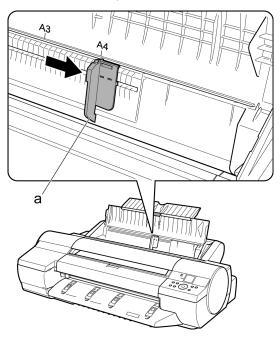
6 印刷面を上にし、[手差し上面給紙口]に用紙をセットします。 その際、用紙の先端が軽く突き当たる所まで、差し込んでください。
