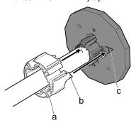
5 図のように[ロールホルダー]を横に置いて、ロール紙の先端を手前に向けて、ロール紙を左側から[ロールホルダー]に差し込みます。[フチなし印刷用スペーサー]を取り付けていない場合は、ロール紙を[ロールホルダー]のフランジ(a)に突き当たるまでしっかりと差し込みます。[フチなし印刷用スペーサー]を取り付けた場合は、[フチなし印刷用スペーサー]に突き当たるまでしっかりと差し込みます。
