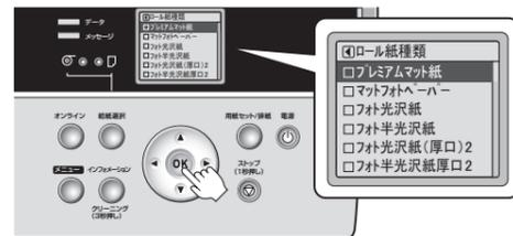
自動的に [プリントヘッド] の位置調整が始まります。[プリントヘッド] の位置調整には、約 13 分かかります。[プリントヘッド] の位置調整が完了すると、[ディスプレイ] に [オンライン] と表示されます。
