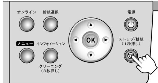
プリンタのウィンドウに中止対象のジョブが無い場合(プリンタへの印刷データの送信が終了した場合)は、以下の操作を行います。
