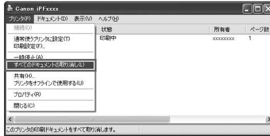
[操作パネル]から印刷を中止する場合は、以下の操作を行います。
