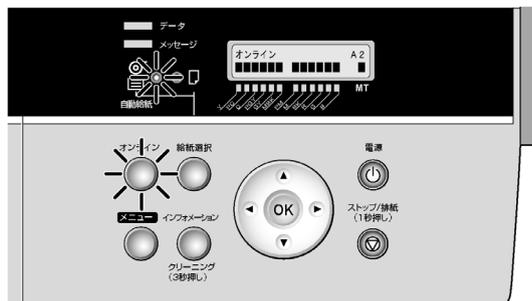
[ディスプレイ]に、[インクリョウカクニン:xx] (xxはインク色)、[インクサンリョウナシ]、[インクタンクカクニンシテクダサイ:xx] (xxはインク色)、[インクタンクコウカンシテクダサイ:xx] (xxはインク色)、[オンラインキーオシテクダサイインサツカイシシマス]、[ヒツヨウインクリョウフソク]が表示されているときに、[インクタンク]を交換できます。
