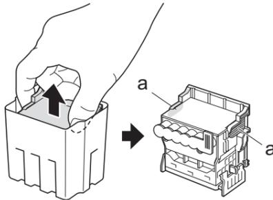
**13** オレンジ色の[保護キャップ1](a)を取り外し、[保護キャップ2](b)をつまみ(c)を押しながら下に引いて取り外します。
