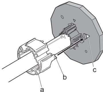
**39** ロール紙の先端を上手前に向けて、ロール紙を左側から [ ロールホルダー ] に差し込みます。ロール紙は [ ロールホルダー ] のフランジ (a) に突き当たるまでしっかりと差し込みます。しっかりと突き当たっていないと、給紙不良の原因になります。
