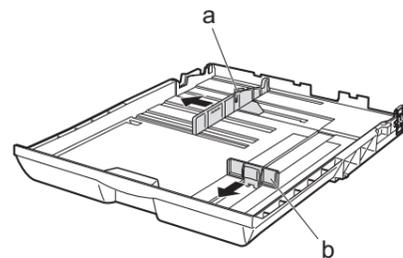
**30** 印刷面を下にし、用紙をさばいてから縦長に揃えて [カセット] の右奥側にセットします。
