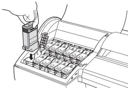
**24** [インクタンク固定レバー] を、カチッと音がするまで閉じます。[インクランプ] が赤く点灯していることを確認します。
