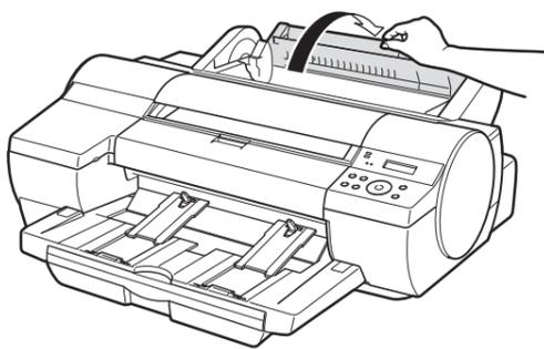
**45** ロール紙の先端を上手前側に向け、[ロールホルダー] の軸を [ロールホルダースロット] の左右のガイド溝 (a) に合わせてセットします。このとき、ガイド溝の色と [ロールホルダー] の軸 (b) の色が同じになるようにセットします。
