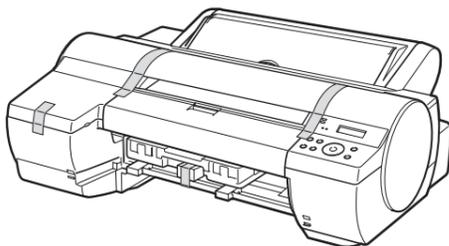
**5** [上カバー]を開き、[キャリッジシャフト](a)の[ベルトストッパ](b)を持ち上げ、手前に引っ張って取り外します。
