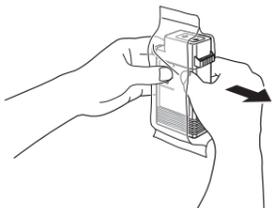
**23** インク供給部を下側、図の向きにして [インクタンク] をホルダーにセットします。
