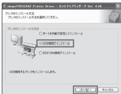
**7** 以下のダイアログボックスが表示されたら、プリンタの電源がオンになっていることを確認し、USB/IEEE1394 ケーブルでプリンタとコンピュータを接続します。
