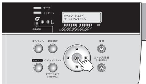
自動的に [プリントヘッド] の位置調整が開始されます。[プリントヘッド] の位置調整には、約 11 分かかります。[プリントヘッド] の位置調整が完了すると、[ディスプレイ] に [オンライン] と表示されます。
