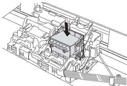
**15** [プリントヘッド固定カバー] を前側に倒して、[プリントヘッド] をロックします。
