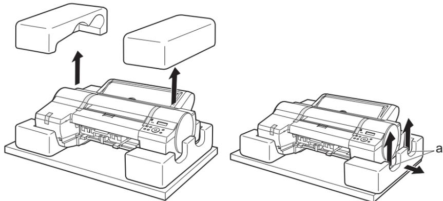
**2** プリンタをの左右底面の[運搬用取っ手](a)を両側から持ち、テーブルなどの水平な場所に置きます。このプリンタの重量は約50kgあるため、持ち運ぶときは、必ず2人以上で左右底面の[運搬用取っ手](a)をしっかりと持ってください。
