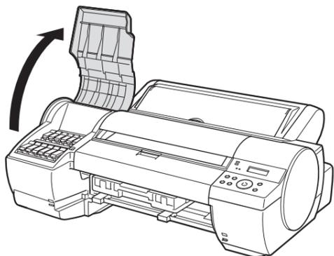
**20** セットする色の [インクタンク固定レバー] の先端ストッパーを押して、[インクタンク固定レバー] を上に開きます。
