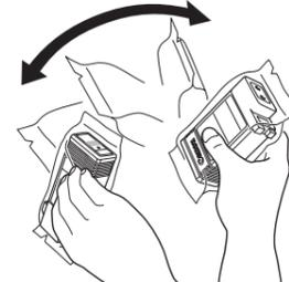
**メモ** • [インクタンク] を振らないと、インクの成分が沈殿し、印刷品質が低下する場合があります。
