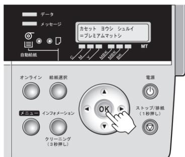
**36** [▶] キー、[◀] キーを押して用紙のサイズを選択し、[OK] キーを押します。自動的に [プリントヘッド] の位置調整が開始されます。[プリントヘッド] の位置調整には、約 9 分かかります。[プリントヘッド] の位置調整が完了すると、[ディスプレイ] に [オンライン] と表示されます。
