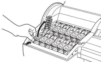
**21** セットする色の [インクタンク] を、袋から開封する前にゆっくりと 7 ~ 8 回振ります。[インクタンク] の上下が逆さまになるように、ゆっくり回転させながら [インクタンク] を振ります。
