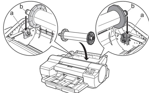
注意 • セットする時に、ガイド溝 (a) と [ロールホルダー] の軸 (b) の間に指が挟まれないように注意してください。
