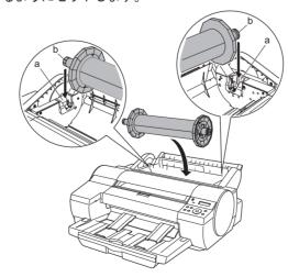
▲・セットする時に、ガイド溝(a)と[ロールホル 対一]の軸(b)の間に指が挟まれないように注 意してください。
