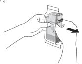
・インク供給部 (a) や端子部 (b) には、 終対に触れないでください。周辺の汚 損、[インクタンク] の破損、または 印刷不良の原因になります。
