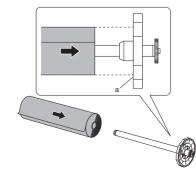
4. [ホルダーストッパ]を左側から[ロールホルダー] に差し込み、[ホルダーストッパ]のフランジ(a) がロール紙に突き当たるまでしっかりと押し込みます
