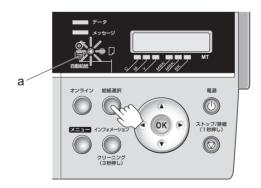
●・[給紙選択] キーを押すと、[自動給紙ランプ]メモ と [手差しランプ] の点灯が切り替わります。
