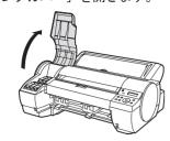
2. セットする色の [インクタンク固定レバー] の先端 ストッパーを押して、[インクタンク固定レバー] を上に開きます。
