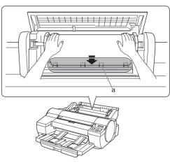
10. [自動給紙ランプ] (a) が点灯し、給紙動作が開始します。
