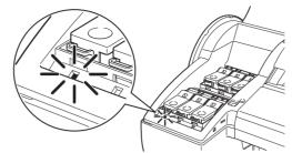
・インクの残量が少なくなると、[インクランプ]メモ がゆっくり点滅します。
