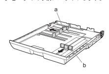
4. 印刷面を下にし、用紙をさばいてから縦長に揃えて [カセット] の右奥側にセットします。
