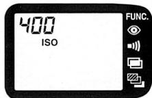
2 電子ダイヤルを回してフィルムの感度をセットします。
