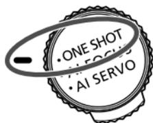
シャッターボタンを半押しするとAFが作動し、1回だけピントを合わせます
