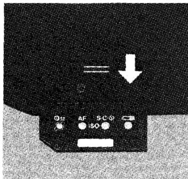
1) メインスイッチ⑩をL以外の位置(□, A, または(∞))に合わせます。このとき表示パネル①に液晶表示が出ます。(もし表示が出ないときは、電池の向きが正しいか確認してください。)
