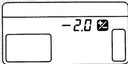
露出アンダー側に2.0段補正
