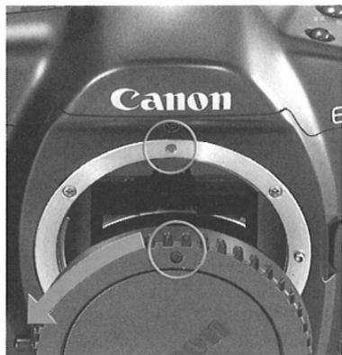
**1** カメラのボディキャップを矢印方向に回して外します。
