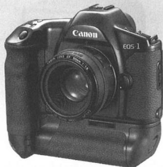
カメラ本体の給送速度をアップさせるためのブースターです。取り付けるとカメラ単体の2モーターから3モーターシステムとなり、最高連続撮影速度が秒間(約)、2.5コマから5.5コマとなります。
