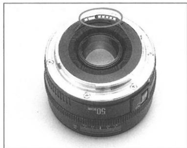
レンズを外したときは、電気接点やレンズ面を傷つけないように、取り付け面を上にして置いてください。
