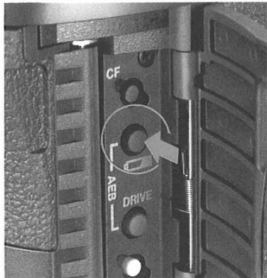
**2** カメラ側面のカバーを開けて、バッテリーチェックボタンを押します。
