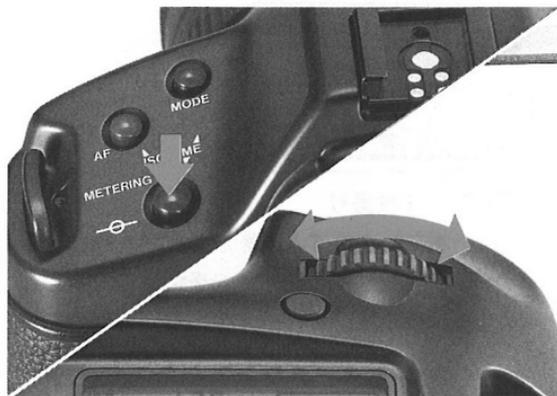
測光モード切り換えボタン(METERING)を押しながら、メイン電子ダイヤルを回して表示パネルにセットします。
