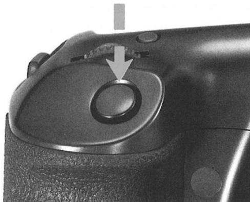
シャッターボタンは2段スイッチになっており、ピント合わせ、測光および撮影を行います。軽く押すとスイッチONとなり、ピント合わせと測光が行われます。測光結果はファインダーに表示されます。
