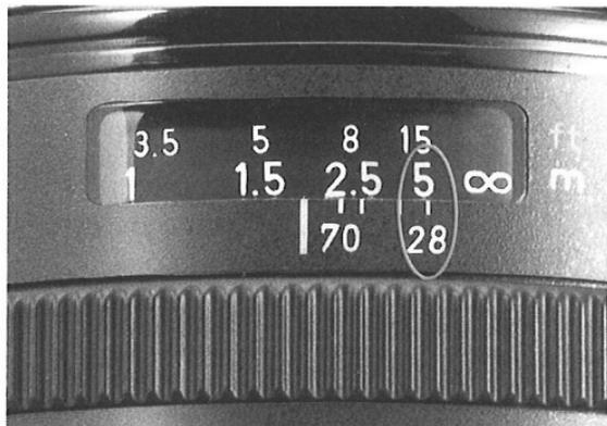
**2** ピント合わせの結果が5mならば、レンズの距離目盛りの5を赤外マーク位置にずらしませす。(写真は28mm使用時)
