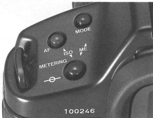
使用頻度の高い3つのボタンを、カメラ上部に配置しています。これらのボタンはメイン電子ダイヤルと併用して、撮影モード(MODE)、オートフォーカスモード(AF)、測光モード(METERING)の選択を行います。
