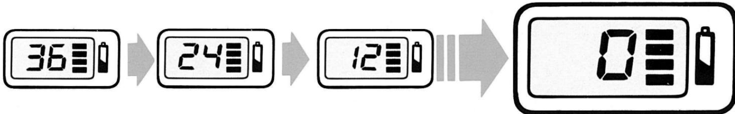
このカメラはフィルムを最後まで撮り終えると数秒後に自動的に巻き戻しを始めますので、フィルムの巻き戻し操作は不要です。巻き戻し中は、フィルムカウンター⑭が逆算します。フィルムを全部巻き終えるとカメラは自動停止します。
