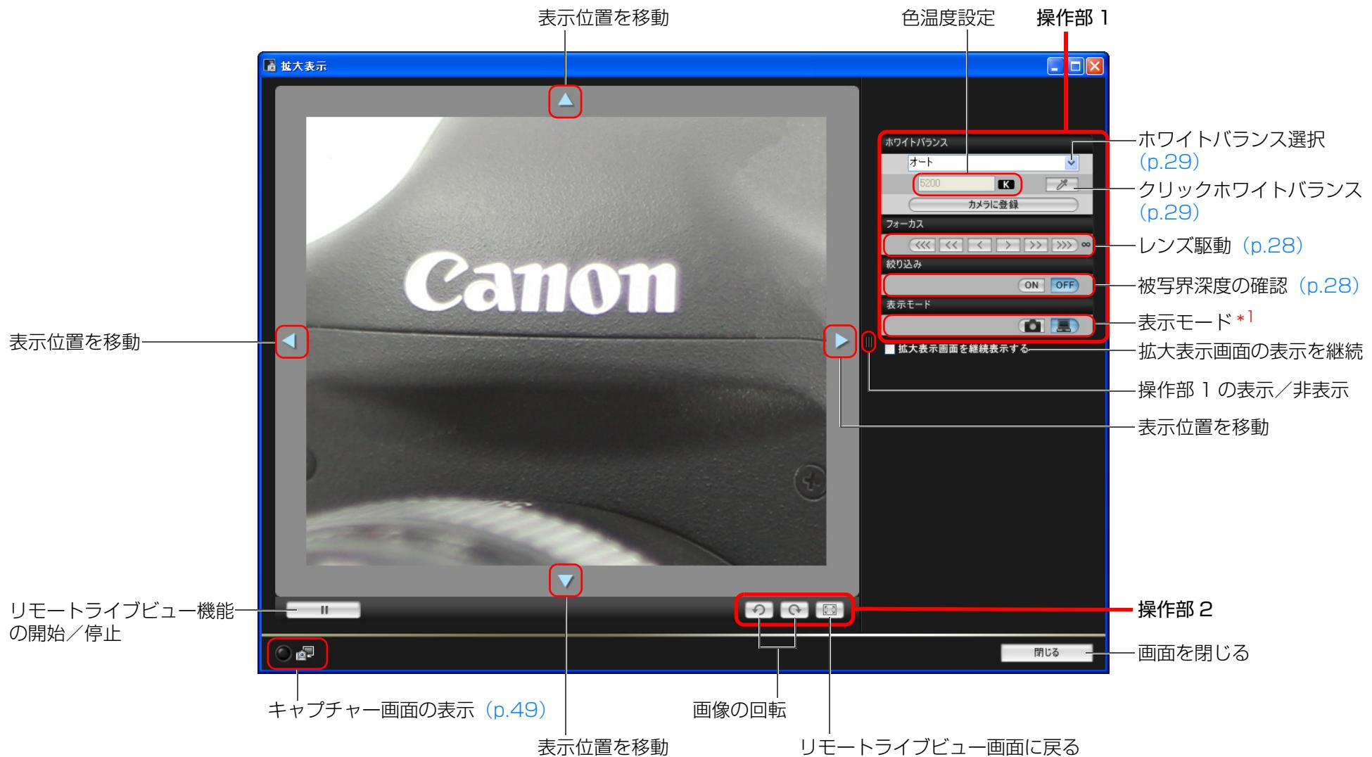
\*1 [ ] ボタンを押すと、カメラの液晶モニターを見ながらピントを合わせるのに適した画質になり、[ ] ボタンを押すと、パソコンの画面を見ながらピントを合わせるのに適した画質になります。
