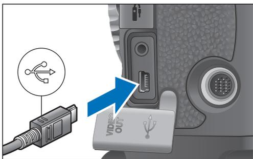
● プラグの〈・⇄〉マークをカメラの前面に向けて差し込みます。
