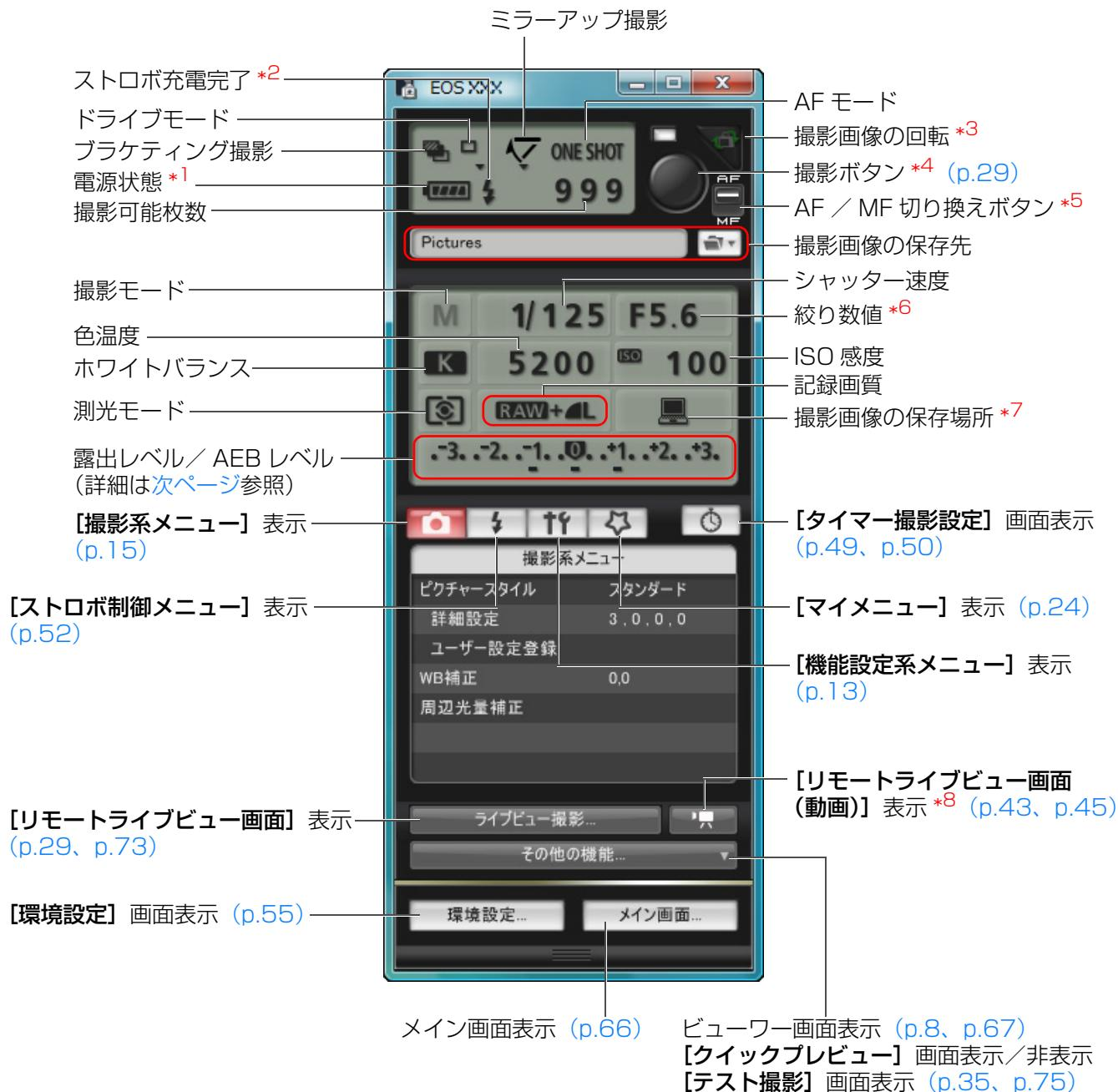
\*1 バッテリーを使っているときは、バッテリー残量が表示されます。
