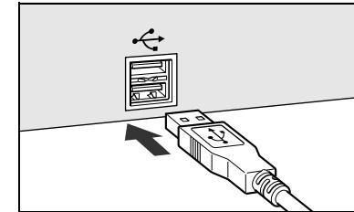
**2** 専用ケーブルのプラグをカメラに接続する
