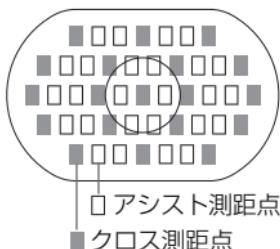
■ で示した19点のAFフレームで、より高精度なクロス測距（縦横線同時検出）を行なうことができます。クロス測距時の縦線検出は、横線検出の約2倍の敏感度で行われます。残る26点のアシスト測距点では、横線検出によるAF撮影になります。
