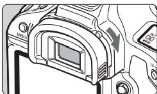
ファインダーから目を離して撮影すると、ファインダーから入った光の影響によって、適切な露出で撮影できないことがあります。そのようなときは、アイピースシャッターレバーを矢印の方向に操作して、ファインダーを遮光します。
