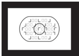
エリアAFフレーム内には、合計45点（19点：高精度クロス測距点、26点：アシスト測距点）のAFフレームが配置されています。任意に選択できる19点の中から適切なAFフレームを選択することにより、構図優先のAF撮影を行うことができます。
