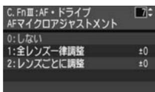
AFによるピント合焦位置を微調整することができます。調整範囲は、±20ステップ（-：前方方向/+：後方方向）です。
