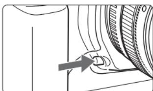
絞り込みボタンを押すと、そのとき設定されている絞り数値で絞り込みが行われ、被写界深度（ピントの合う奥行き）をファインダーで確認できます。
