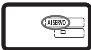
撮影距離がたえず変化する（動いている）被写体の撮影に適しています。シャッター ボタンを半押ししている間、被写体にピントを合わせ続けます。
