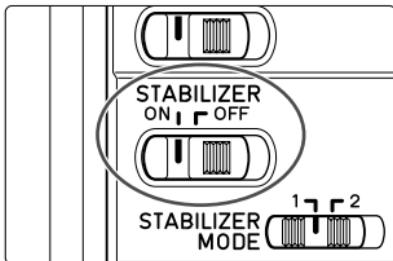
1 手ブレ補正スイッチを ON にします。
