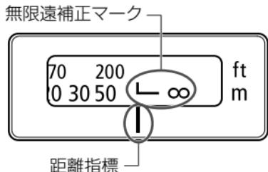
温度変化によるピント移動を補正するため、無限遠（∞）位置に余裕を持たせてあります。
