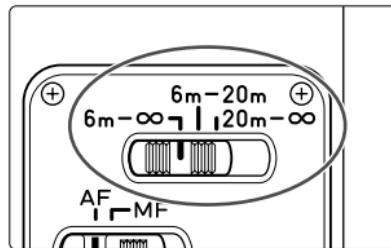
6m-∞、6m-20mまたは20m-∞の撮影距離範囲をスイッチで選べます。撮影距離に応じた設定にすることで、AF作動時間が短くなります。
