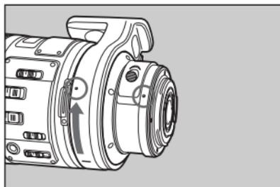
**2** 三脚座を回転させて、三脚座の取り付け指標とレンズの取り付け指標を合わせます。
