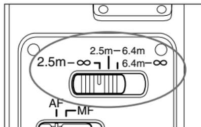
撮影距離範囲をスイッチで選べます。撮影距離に応じた設定にすることで、AF作動時間が短くなります。
