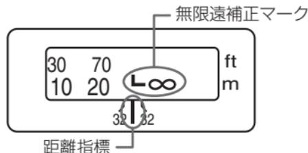
温度変化によるピント移動を補正するため、無限遠（∞）位置に余裕を持たせてあります。常温の無限遠位置は、Lマークの縦線と距離指標が合うところ です。
