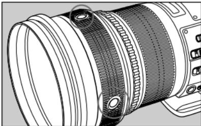
AF作動中にAFストップボタンを押すと、AFを一時中断することができます。シャッターボタンを半押しした状態で、AFストップボタンを離すと、AFが再開します。
