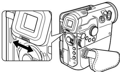
電源を入れ、ファインダー内の表示がはっきり見えるように、視度調整レバーを動かして調整します。
