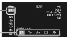
**P**（プログラムAE）：シャッタースピードとしぼりが自動で設定される。
